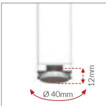
Spitzen mit Nivellierfüßen aus Polyethylen, Durchmesser 40 mm, Auslenkung 0-12 mm.
